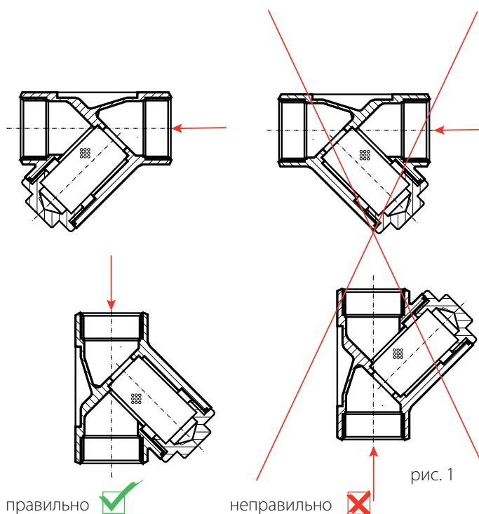
При установке фильтров сетчатых на пар, на горизонтальном паропроводе необходима установка крышки вбок во избежание заполнения стакана фильтра конденсатом. Установка в вертикальном положении возможна только при направлении потока сверху вниз (крышка вниз).
